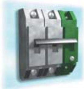
O dispositivo DR é um interruptor automático que desliga correntes elétricas de pequena intensidade (da ordem de centésimos de ampère), que um disjuntor comum não consegue detectar, mas que podem ser fatais se percorrerem o corpo humano.
