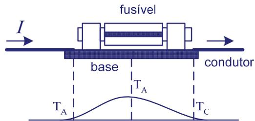
O condutor e o elemento fusível são percorridos por uma corrente admissível que os aquece. A temperatura do condutor deverá assumir um valor constante em toda a sua extensão. Devido a resistência do elo fusível este sofre um aquecimento maior, atingindo na parte central uma temperatura  $T_B$ , o qual a partir deste valor é transferida para o meio ambiente. A temperatura  $T_A$  não deve ultrapassar a um determinado valor para não prejudicar a vida útil do isolamento do elemento condutor.
