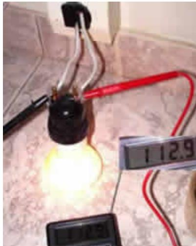
medição da corrente do aterramento com lâmpada
