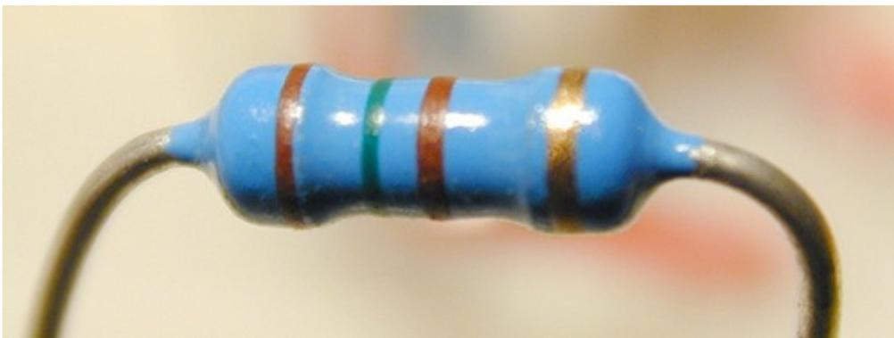
*Resistor: Componente de circuito que produz calor quando submetido à corrente elétrica*
