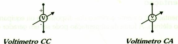
O voltímetro CC possui um pólo positivo (vermelho) e um negativo (Preto), nos quais são colocadas as pontas de prova, utilizadas para conectá-lo nos pontos onde se deseja medir a tensão. No voltímetro CA, não há polaridade.
