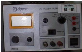
Fonte de alimentação é o nome genérico dos dispositivos ou equipamentos que fornecem tensão a um circuito elétrico. A fonte de alimentação pode ser um gerador de tensão, uma pilha ou uma bateria.
