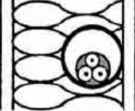
Face interna | Cabo multipolar em eletroduto de seção circular embutido em parede termicamente isolante <sup>2)</sup>                                                    | A2                                 |
