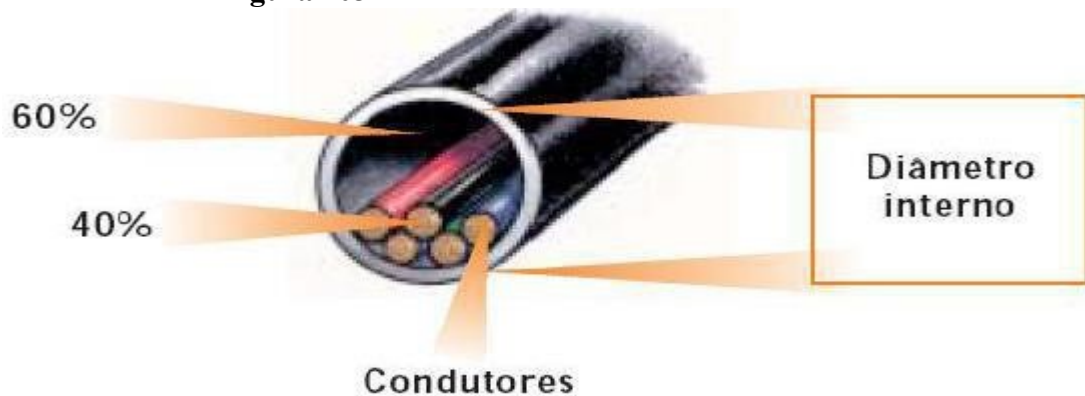
Figura 103 – Condutores no interior do eletroduto.
