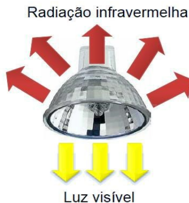
Figura 12 – Dissipação da luz visível e infravermelha.
