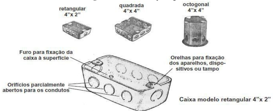
Figura 50 – Caixas de passagem.
