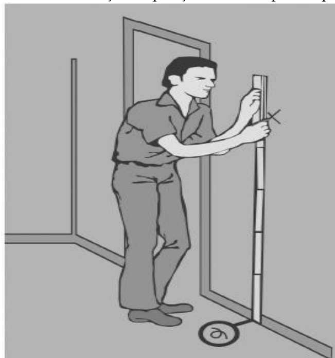
Figura 131 – Marcação da posição do interruptor na parede.
