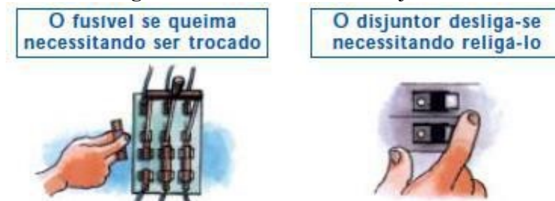
Figura 205 – Fusível versus disjuntor.
