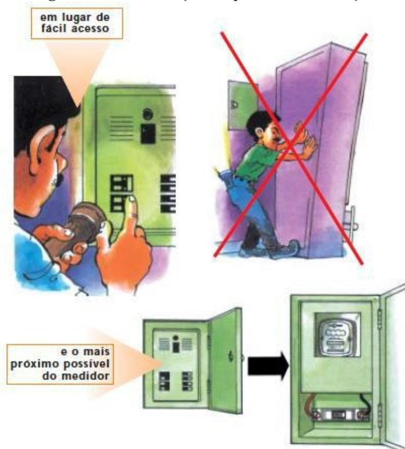
Figura 218 – Localização do quadro de distribuição.
