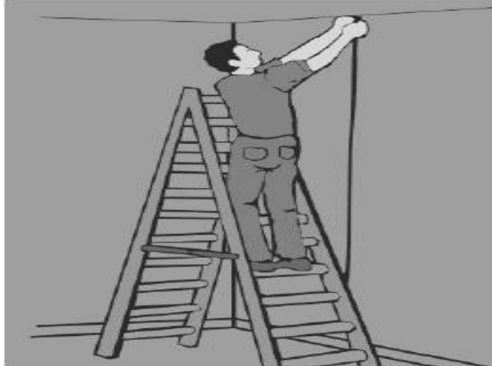
Figura 132 – Marcação do caminho do eletroduto na parede.
