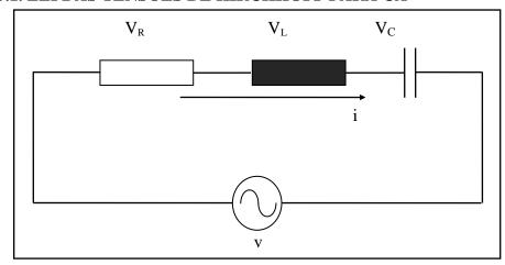
Aplicando a lei de Kirchhoff de tensão ao circuito acima resulta:  $ec{V}=ec{V}_R+ec{V}_L+ec{V}_C$
