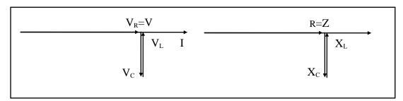
Nesse caso, toda a energia reativa é trocada entre o indutor e o capacitor, e a fonte fornece apenas a energia para o resistor. Para a fonte, o circuito é resistivo puro. A impedância do circuito fica igual a resistência, e é portanto a menor possível.
