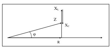
Se a frequência for reduzida, o circuito vai aproximando-se da ressonância, até que  $X_L=X_C$ . Nessa condição,  $2.\pi.f.L=1/(2.\pi.f.C)$ .
