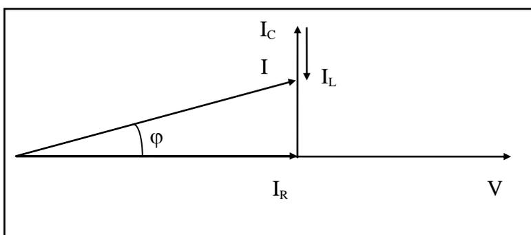
Vemos que se forma um triângulo retângulo cujos catetos são a corrente no resistor e a diferença das correntes reativas, e a hipotenusa é a corrente total da associação. Aplicando trigonometria e teorema de Pitágoras
