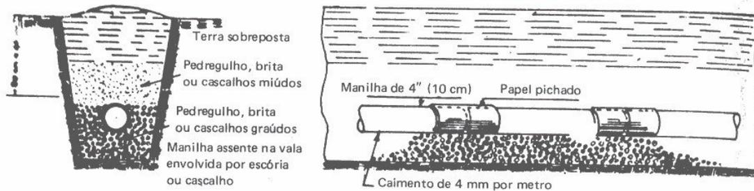
Figura 32. Vala de infiltração.
