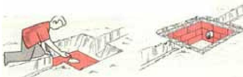
Figura 31. Construção da caixa de inspeção.
