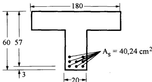
Estamos em condição de Momento Fletor extremamente alto para esta seção resultando em uma área de aço muito grande. Face a isso temos aço demais para alojar em uma pequena área. Tivemos que colocar aço em posições mais altas e com isso altera-se a nossa suposição de que a área do aço estivesse a 57 cm (d) da extremidade superior da aba. No caso presente como temos uma camada de aço fora da distância de 57 cm, deveríamos considerar uma outra distancia d, digamos cerca de 54 cm.
