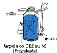
Figura 23. Extintor de pó químico seco.
