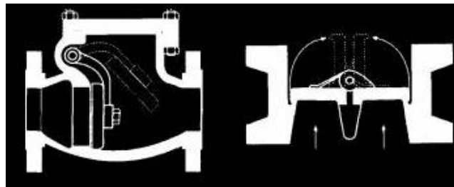
Figura 59. Válvula de retenção tipo portinhola basculante única e portinhola dupla.
