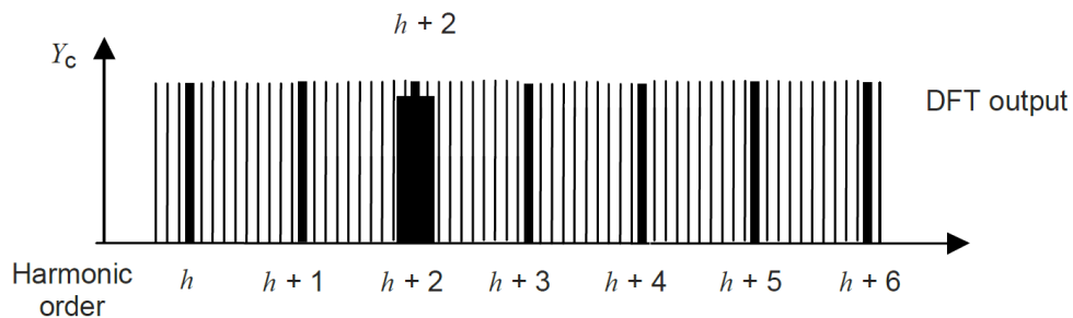
Figura 5.61 Agregação de componentes espectrais para cálculo de coeficientes do espectro.
