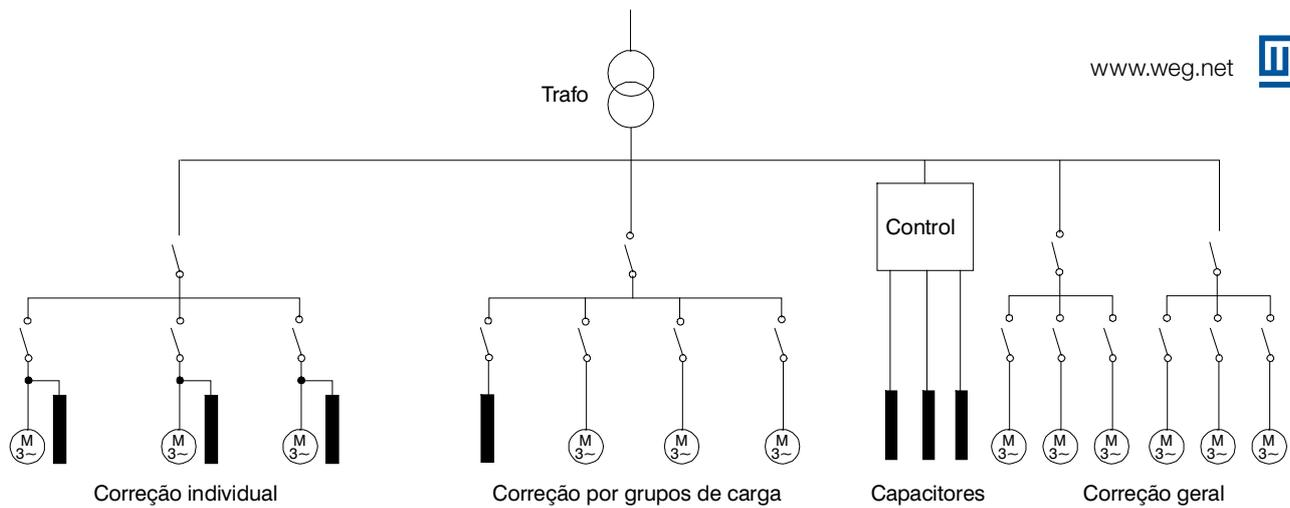
Diagrama dos Tipos de Instalação
