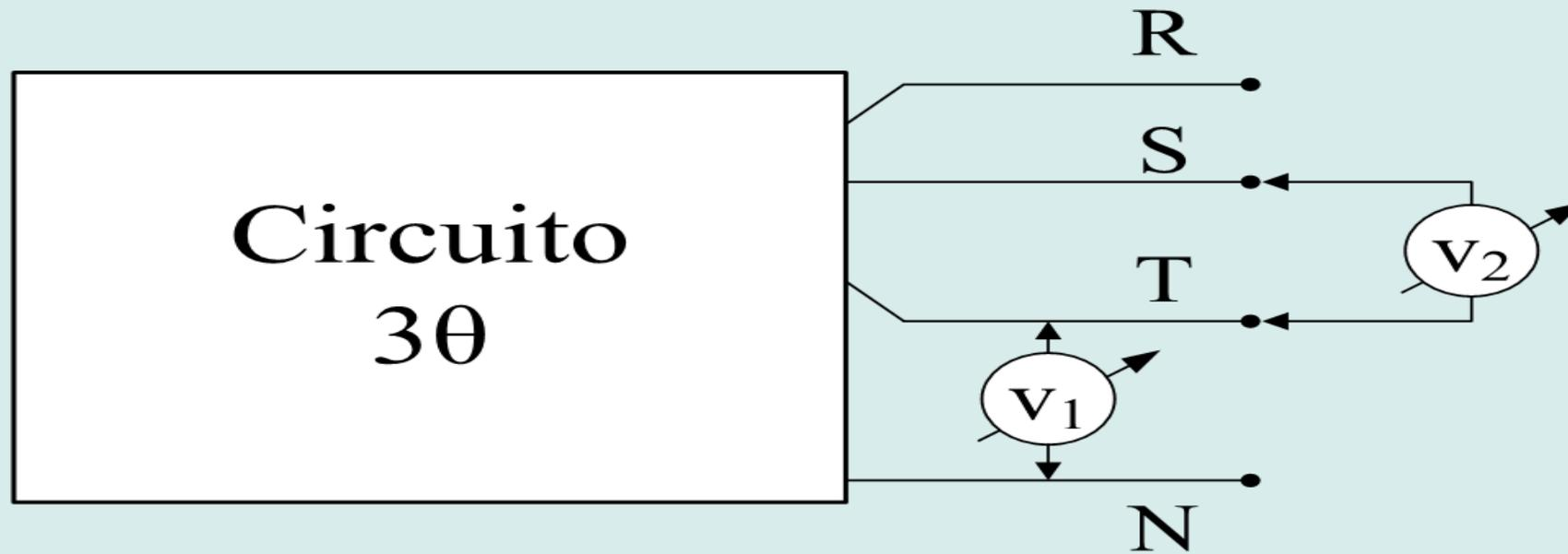
Voltímetro  $V_1 \rightarrow V_{\text{fase}} = V_F: V_T, V_R \text{ e } V_S$
