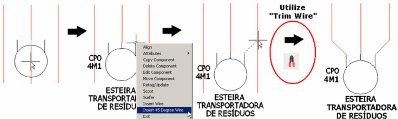
Clique com o botão direito do mouse sobre o ponto indicado na figura, escolha o comando "Insert Wire" e faça um pedaço de fio.
