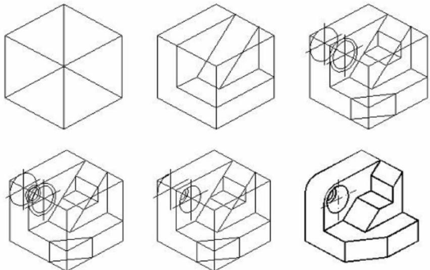
3. Na mesma folha do exercício 2 ou em uma terceira folha de papel A4 (sem margem nem legenda, mas com nome, turma e data informados na parte inferior da folha), desenhe a peça mostrada ao lado em perspectiva isométrica **com instrumentos**. Use a sequência de passos indicada abaixo.
