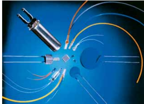
Figura 3.37 Termistores NTC (Coeficiente de Temperatura Negativo, do inglês Negative Temperature Coefficient ) e PTC (Coeficiente de Temperatura Positivo, do inglês Positive Temperature Coefficient ). (Cortesia da Siemens Components, Inc.)
