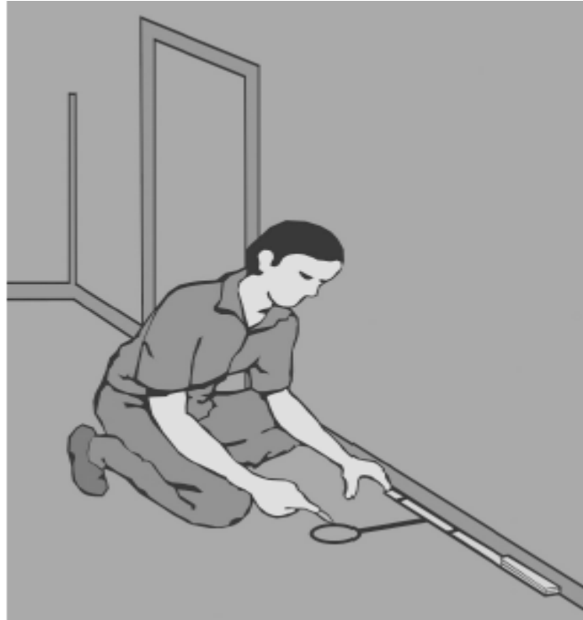
Figura 130 – Marcação da posição do interruptor no piso.
