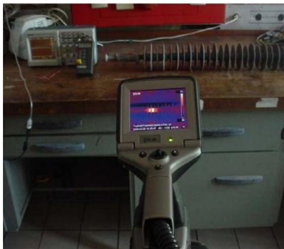
Figura 10.2.2 – Realização de ensaio em isolador polimérico.
